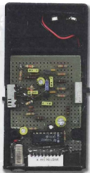
Il circuito visualizzatore montato
